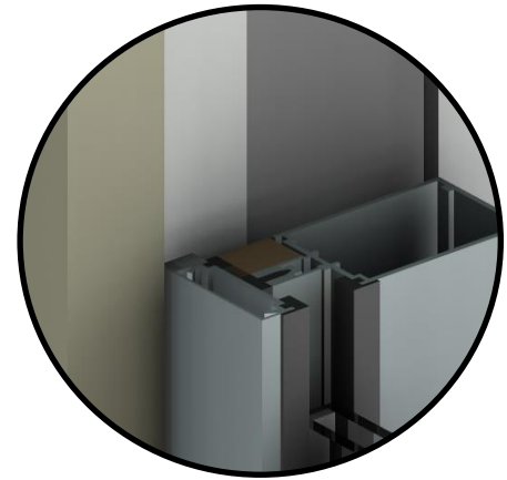
Curtain Wall Jamb Detail
